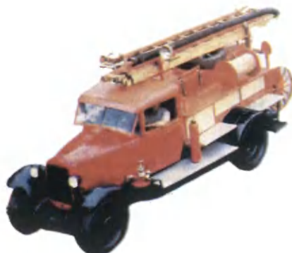
3. Легкая пожарная линейка ПМГ-1 (1932 г.) на шасси грузовика ГАЗ-АА.
