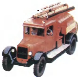
4. Пожарная автоцистерна ПМЗ-2 на шасси ЗИС-5.
