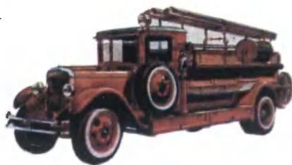
2. Пожарная линейка ПМЗ-1 (1934 г.) на шасси ЗИС-11.
